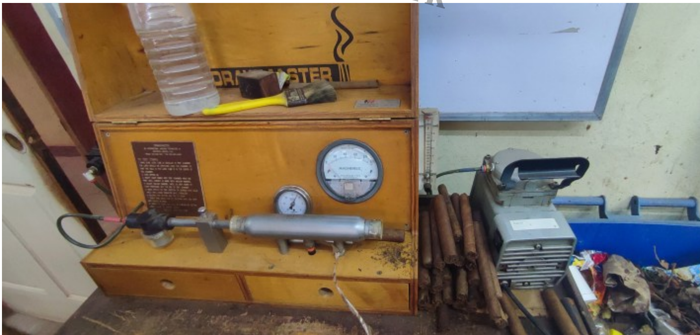
Une machine pour tester que l'air passe bien dans le cigare. A contrario, s'il n'est pas assez rempli, il aura des parties creuses visibles à l'extérieur.
